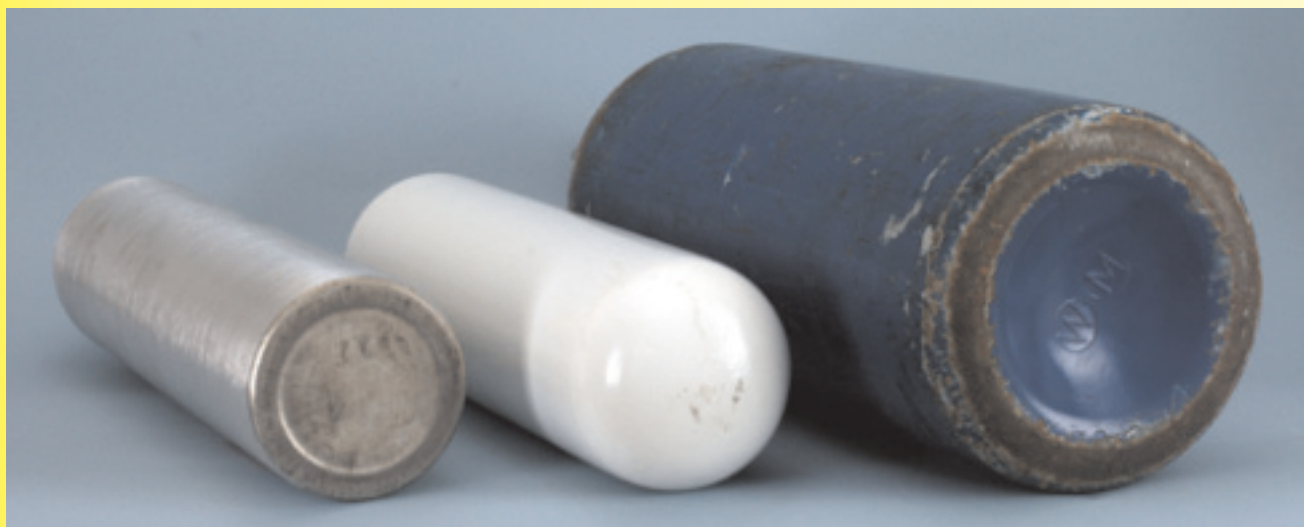
Obr. č. 1 Dna tlakových lahví rovné, konvexní, konkávní
