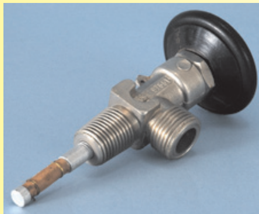
a) Ventil O 2 přímý, připojení W 21,8, závit do lahve malý kužel
